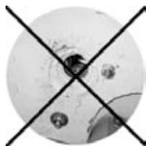
Рисунок 40. Грязное отверстие для силового цилиндра
