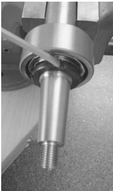
Рисунок 15. Затяжка вращающейся гайки
