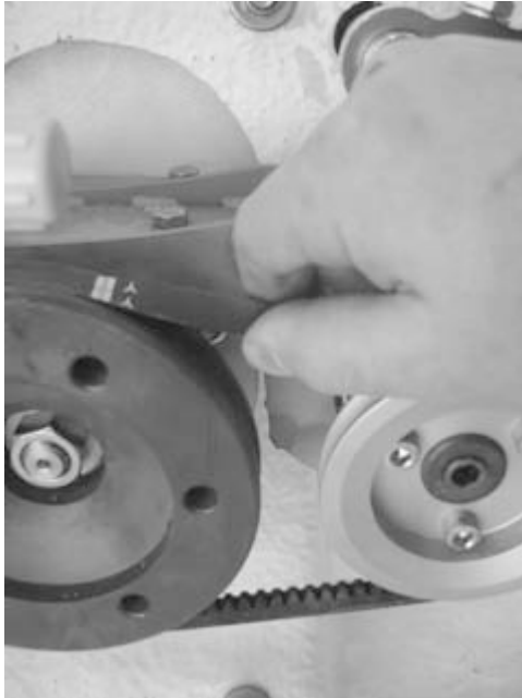
Рисунок 57. Проверка натяжки клиновидного ремня
