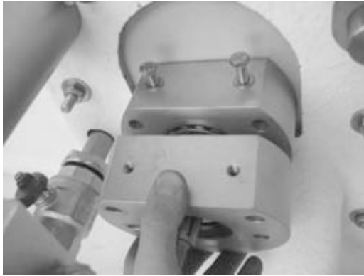
Рисунок 7. Снятие корпуса опорного подшипника
