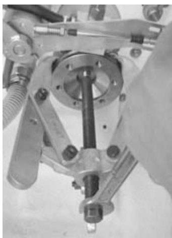
Рисунок 3. Снятие фланцевой муфты с помощью инструмента для извлечения
