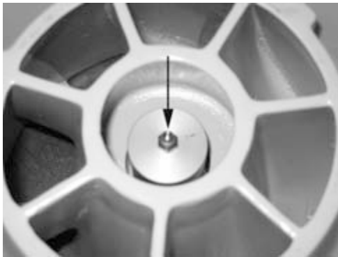
Рисунок 17. Демонтаж корпуса подшипника
