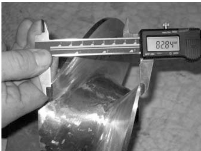
Рисунок 26. Замер размаха лопастей импеллера
