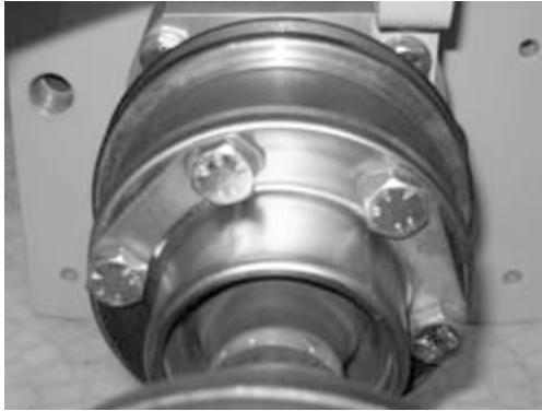
Рисунок 1. Крепежные болты промежуточного вала
